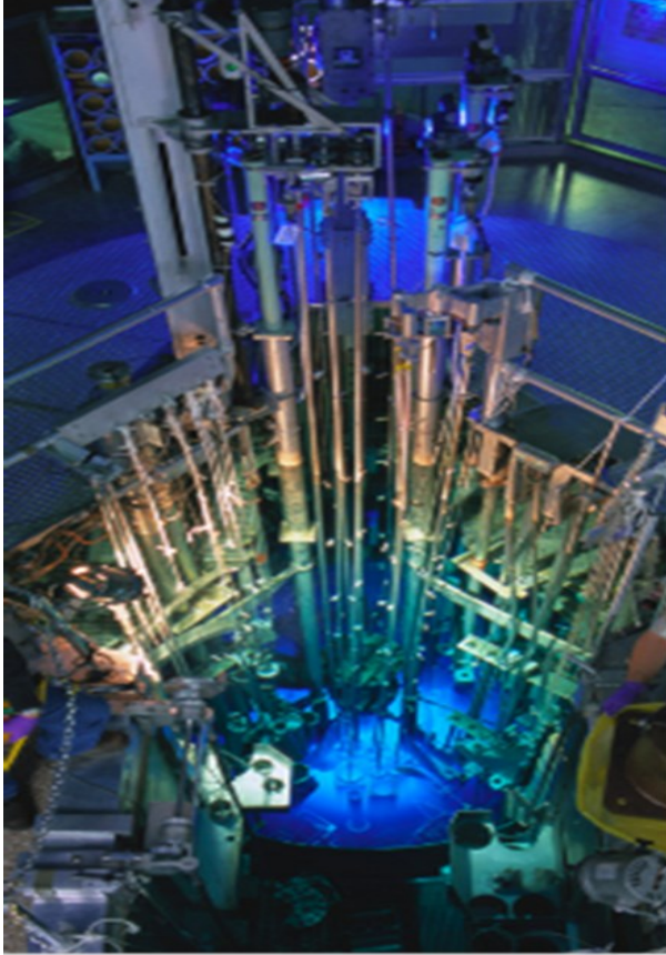
قلب المفاعل النووي تتم فيه تشعيع العينات
